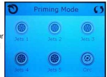
Important : Une pompe ne doit pas être autorisée à fonctionner sans amorçage plus de 2 minutes. Sous AUCUNE circonstance une pompe devrait être autorisée à fonctionner sans amorçage au-delà de la fin des 4-5 minutes du mode d'amorçage. Cela pourrait entraîner des dégâts à la pompe et provoquer l'enclenchement du réchauffeur et entraîner une surchauffe.
