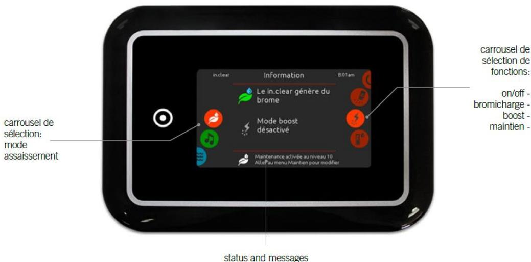
Pour sélectionner le mode d'assainissement, faites tourner le carrousel gauche vers le haut ou vers le bas jusqu'à ce que l'icône du mode assainissement s'allume au milieu de l'écran.
